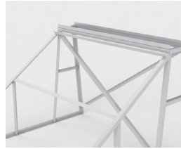
6. 집열판 고정대 상단 볼트를 정공 상부로 고정하고 양쪽 끝 볼트를 끼워 넣습니다.
